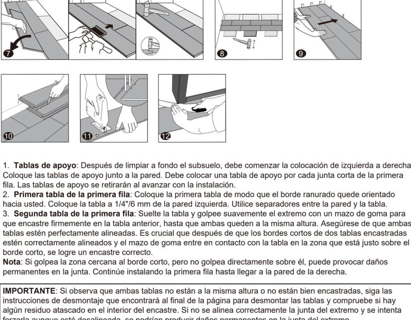
**1. Tablas de apoyo:** Después de limpiar a fondo el subsuelo, debe comenzar la colocación de izquierda a derecha. Coloque las tablas de apoyo junto a la pared. Debe colocar una tabla de apoyo por cada junta corta de la primera fila. Las tablas de apoyo se retirarán al avanzar con la instalación.
